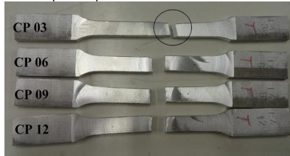
Figura 6 – Corpos de prova submetidos aos ensaios de tração.
